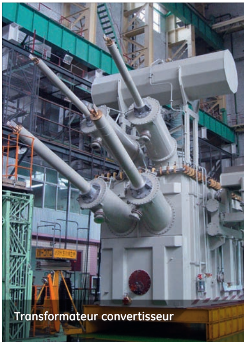
Transformateur convertisseur 301 MVA, 500 kV pour les postes de convertisseurs dos à dos CC de \pm 50 kV
