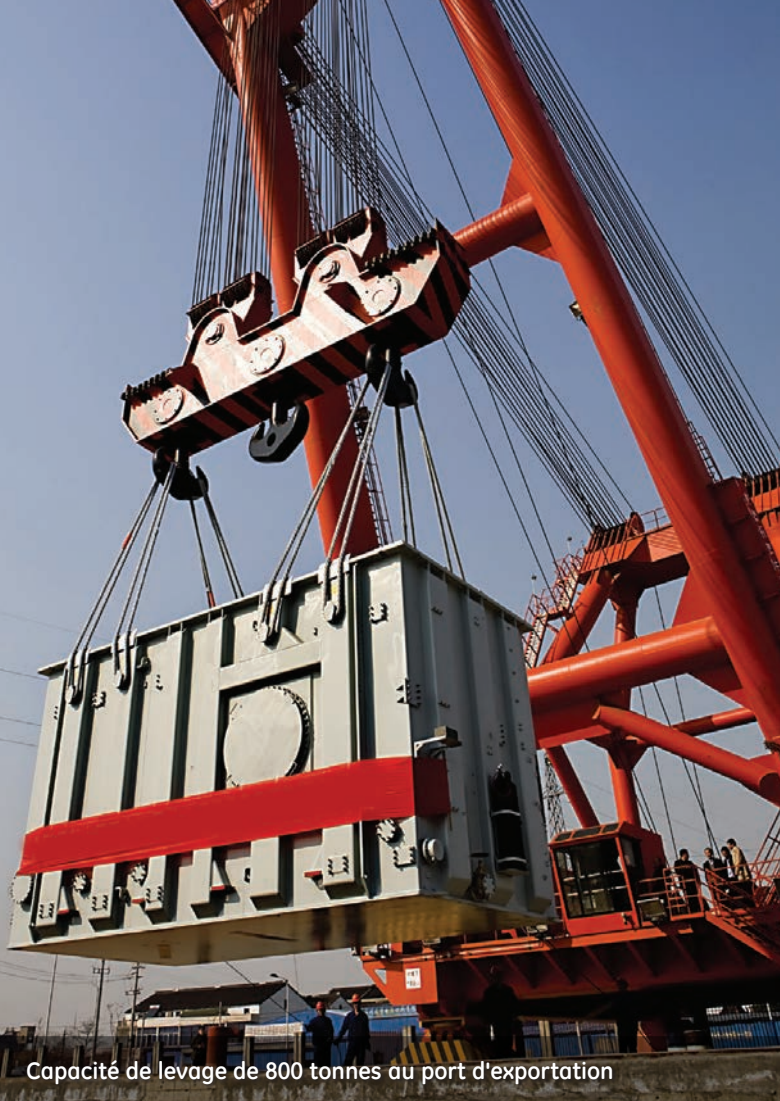
Transformateur convertisseur 800 kV à Xiangjiaba, Shanghai
